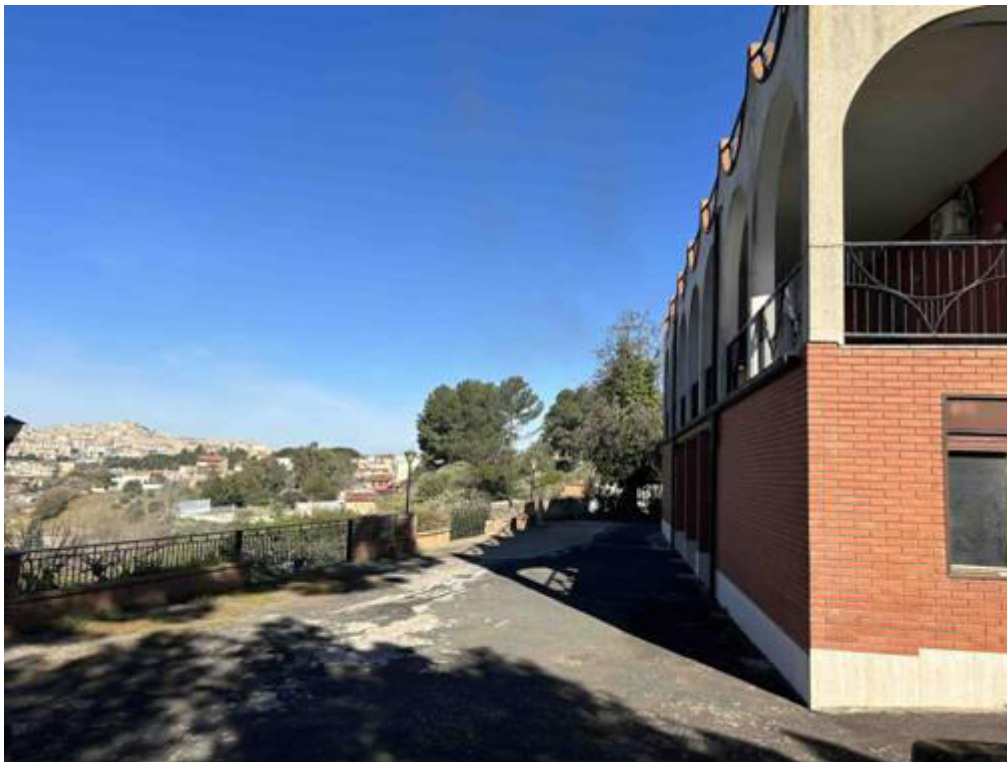
Foto n° 15 – Foto scattata al viale sottostrada (lato sud-ovest). Il viale sottostrada è in conglomerato bituminoso nella porzione adiacente al fabbricato mentre è in conglomerato cementizio nella parte prossima alla recinzione. Si rilevano delle fessure nei punti di unione tra le diverse pavimentazioni.
